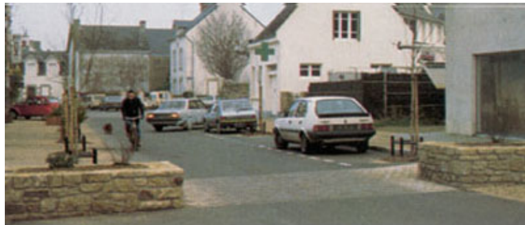
Figura 18 – esempio di restringimento puntuale della carreggiata
